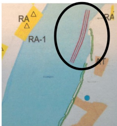
Kuva 28. Korpelan osayleiskaava-alueen länsiosassa olevan AT-rakennuspaikan edustalle rantaviivaan kesän 2016 aikana tehty rannansuojaus. Poneella näkyy perattava uomaosuus ja vihreällä perkausmassojen sijoituspaikat.
