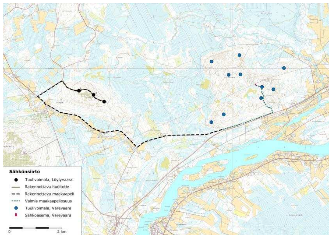
Kuva 2. Löylyvaaran tuulivoimapuiston sähkönsiirto.
