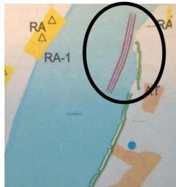
Kuva 28. Korpelan osayleiskaava-alueen länsiosassa olevan AT-rakennuspaikan edustalle rantaviivaan kesän 2016 aikana tehty rannansuojaus. Poneella näkyy perattava uomaosuus ja vihreällä perkausmassojen sijoituspaikat.
