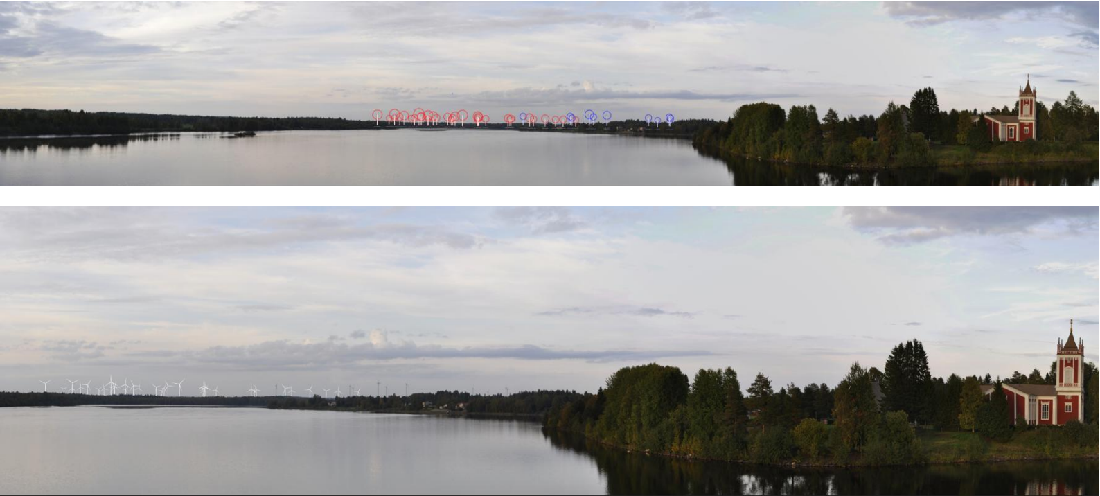
Kuva 41. Havainnekuva hankevaihtoehdosta VE1 kuvauspisteestä 5 Tervolan Siltatie. Etäisyyttä lähimpään Outojäängän VE1 voimalaan on noin 8,7 kilometriä. Kuvassa havainnekuvahahmotelma, jossa roottorit ympyröity näköesteiden päällä, ja kuvan laajuus on kerralla ihmissilmin havaittava näkymä eli noin 180 astetta. Outojäängän roottorit on ympyröity punaisella ja Varevaaran sinisellä. Alla ote havainnekuvaista ilman hahmotelmaviivoja alueelta, jolla Outojäängän ja Varevaaran tuulivoimaloita näkyisi. Vaihtoehdossa VE2 voimaloita näkyy kolme vähemmän.
