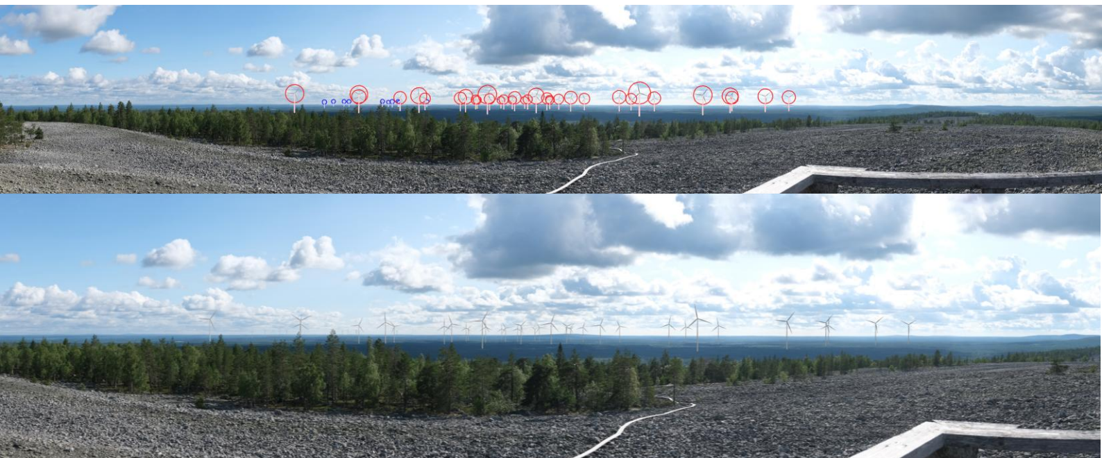
Kuva 36. Havainnekuva hankevaihtoehdosta VE1 kuvauspisteestä 2 Kätkävaaran näköalatorni. Etäisyyttä lähimpään Outojängän VE1 voimalaan on noin 3,6 kilometriä ja vaihtoehdon VE2 voimalaan 4,3 kilometriä. Kuvassa havainnekuvahahmotelma, jossa roottorit ympyröity näköesteiden päällä, ja kuvan laajuus on kerralla ihmissilmän havaittava näkymä eli noin 180 astetta. Outojängän roottorit on ympyröity punaisella ja Varevaaran sinisellä. Alla ote havainnekuvasta ilman hahmotelmaviivoja alueelta, jolla Outojängän ja Varevaaran tuulivoimaloita näkyisi. Vaihtoehdossa VE2 voimaloita näkyy kolme vähemmän.
